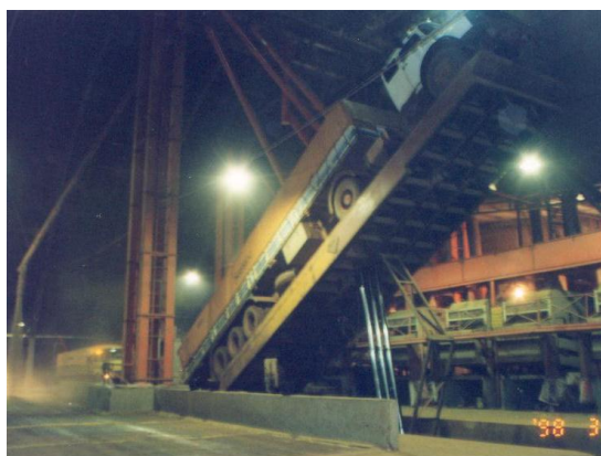
ロンドニア州ポルト・ベレーリョ港での大豆の積み下ろし。30トン積載の大型トラックを持ち上げて、一挙に大豆をサイロに流し込む。 (1998年3月、本郷豊撮影)
