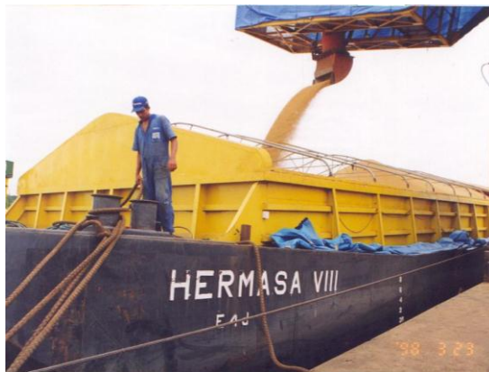
ロンドニア州ポルト・ベリヨ港での大豆をバージに積み込む作業。 バージの船体は、流木対策のため厚い鋼鉄製となっている。 (1998年3月、本郷豊撮影)
