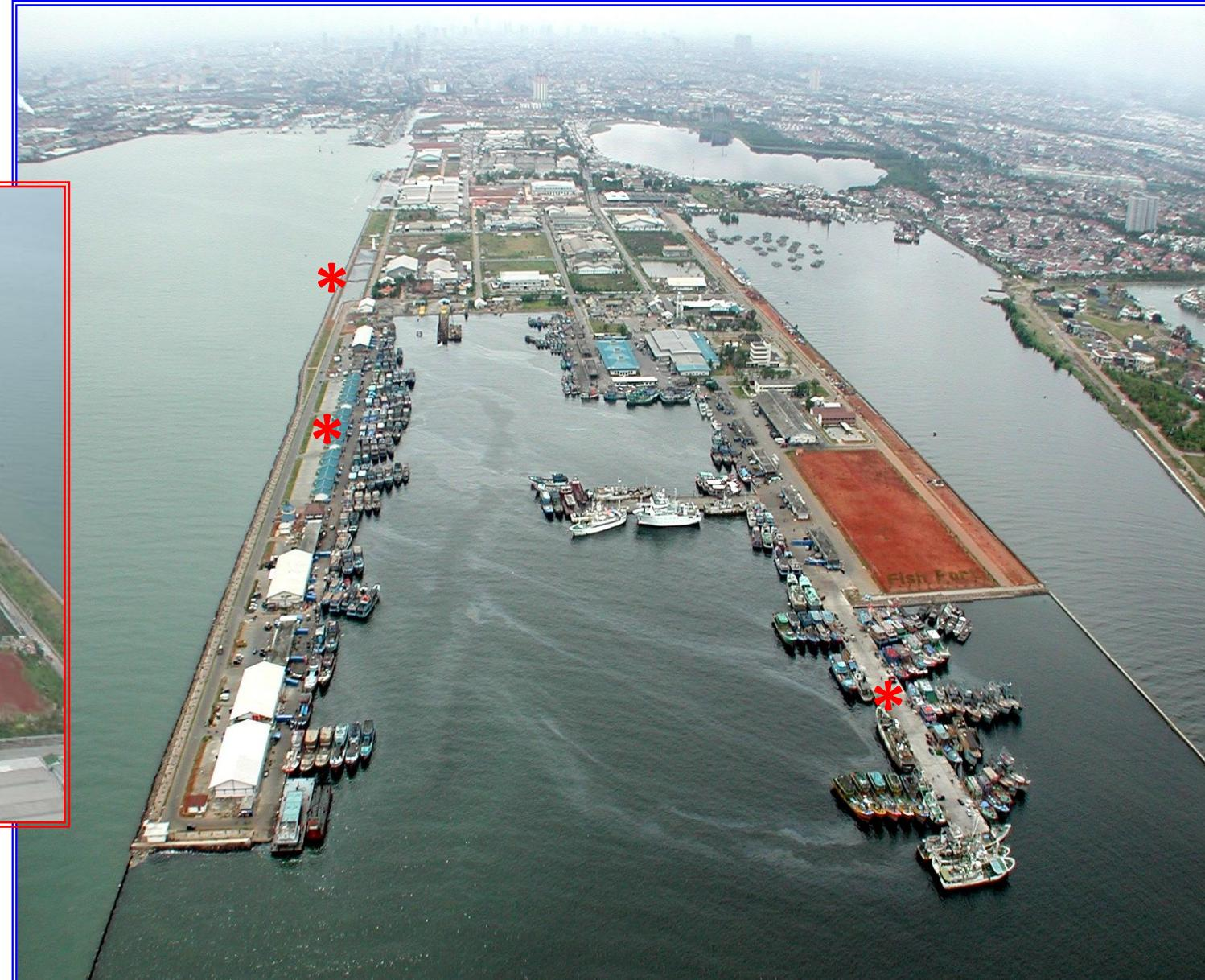
第4期工事完成後(手前右:200mの水深7.5 mの桟橋延長\*、左岸壁
