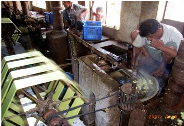
「チャルカ」(座繰り)と呼ばれる伝統的な家内制小規模製糸工場の様子。1人が4緒の揚げ枠(糸を巻き取る枠)を担当している。(写真提供:河上清)
