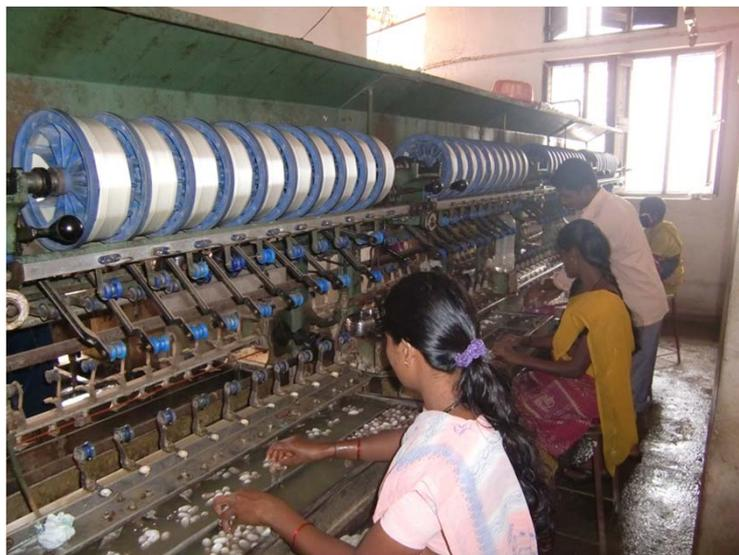
自動式の多条繰糸機を導入した民間製糸工場。1人が10緒の揚げ枠(糸を巻き取る枠)を担当している。(カルナタカ州ラマナガラム、2011年6月山田浩司撮影)
