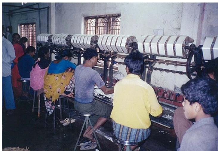
「コテージベイン」と呼ばれる家内制小規模製糸工場の様子。1人が6緒の揚げ枠(糸を巻き取る枠)を担当している。(写真提供:河上清)
